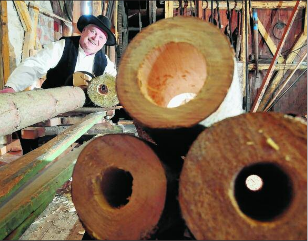
Hans-Jürgen Wenzel in seiner seit 1864 bestehenden Röhrenbohrerei. Hier fertigt er Holzröhren an, die vor allem für denkmalgeschützte Objekte wieder gebraucht werden.
